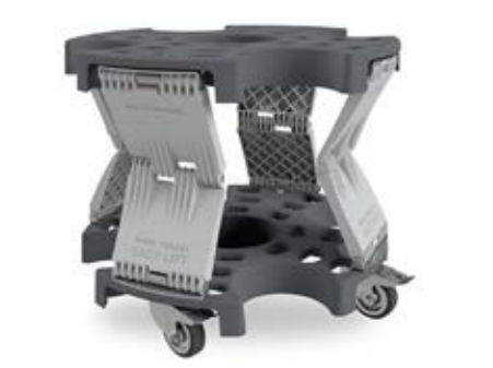
WHEEL TROLLEY EASY LIFT De Wheel Trolley Easy Lift is een gloednieuwe uitvinding en daarbij de meest ergonomische variant binnen het wielentrolley assortiment. Voorkomt fysieke klachten bij werknemers. • Past de hoogte aan in verhouding tot de belasting • Ontworpen voor 4 wielen • Standaard geleverd met remmen op 2 zwenkwielen • Maximale draaggewicht: 180 kg • Diameter: 700 mm • Hoogte: 240-580 mm Art.nr. 3045120
