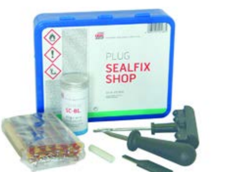
SEALFIX WERKPLAATS-ASSORTIMENT Complete set voor tijdelijke noodreparaties van lekken aan het loopvlak. Inhoud: • 25x koorden • 1x speciaal cement blauw pot 40 gram • 1x handrasp • 1x inbrengwerktuig • 1x krijt • 1x mes en een handleiding
